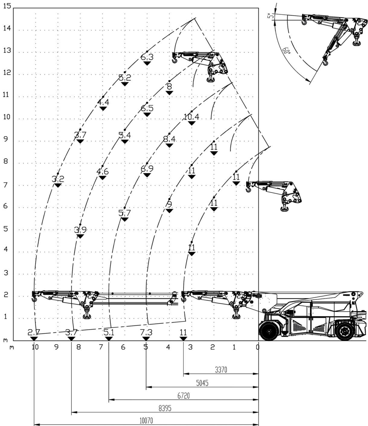
**Flèche de base avec Jib hydraulique extensible 6,5t +crochet avec stabilisateurs**
