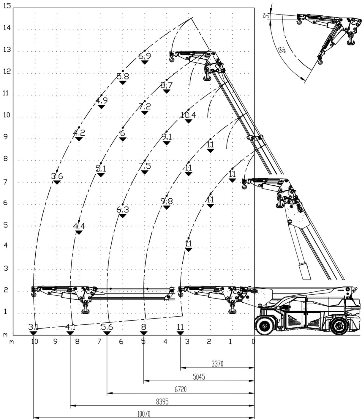
Flèche de base avec Jib hydraulique 11t + crochet avec stabilisateurs
