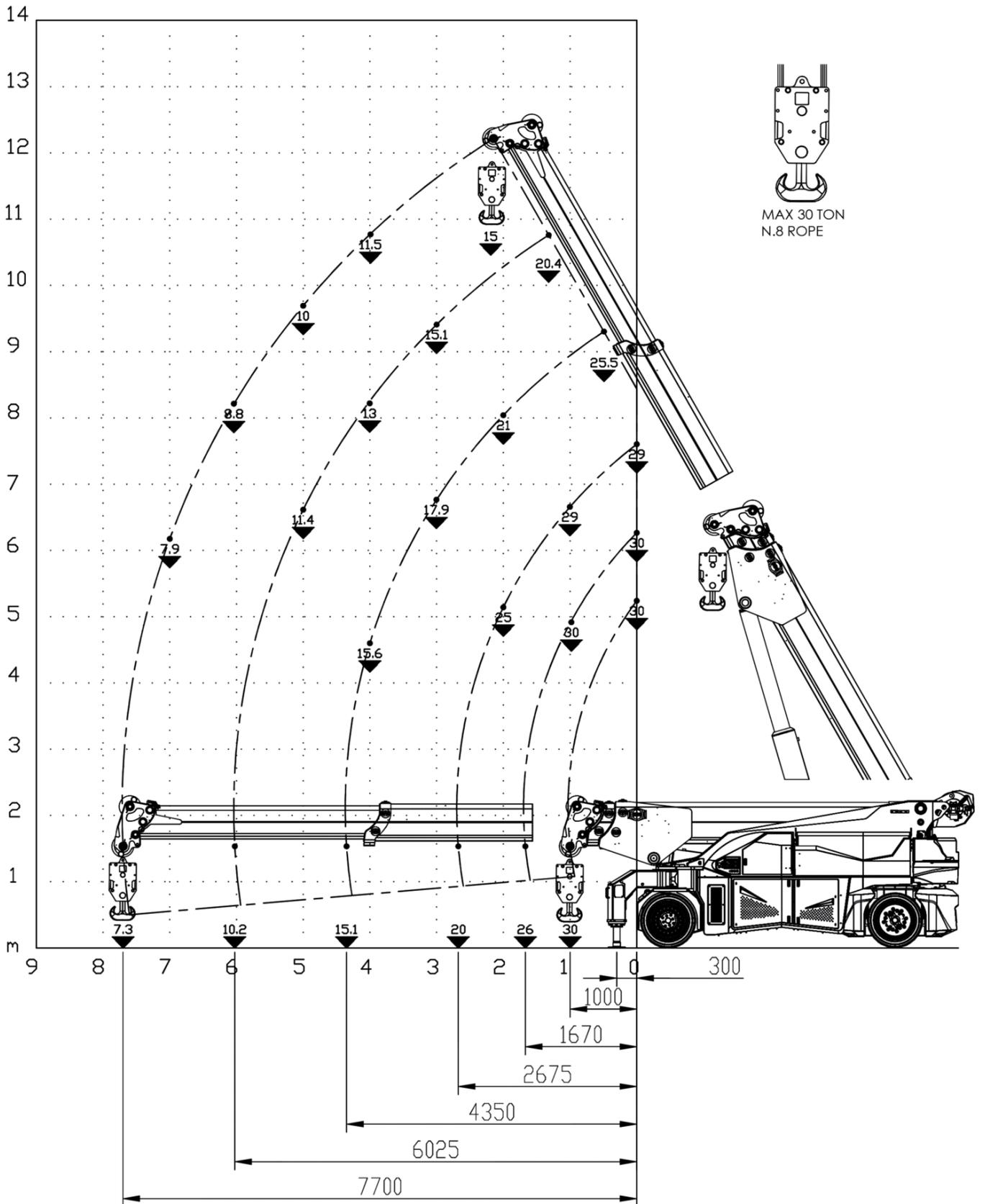
**Flèche de base avec Jib hydraulique 11t + crochet**
