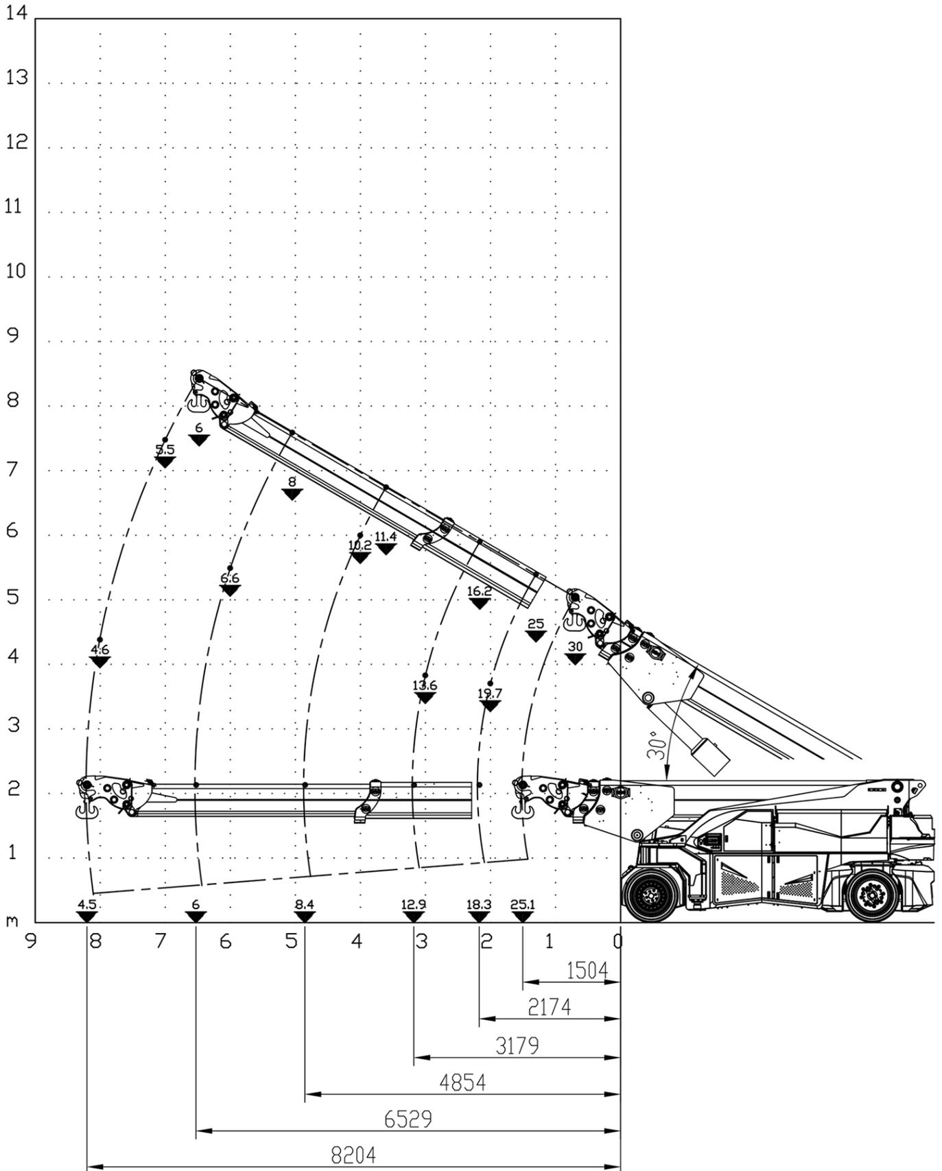
**Flèche de base avec GEKO mécanique a 80° avec stabilisateurs**
