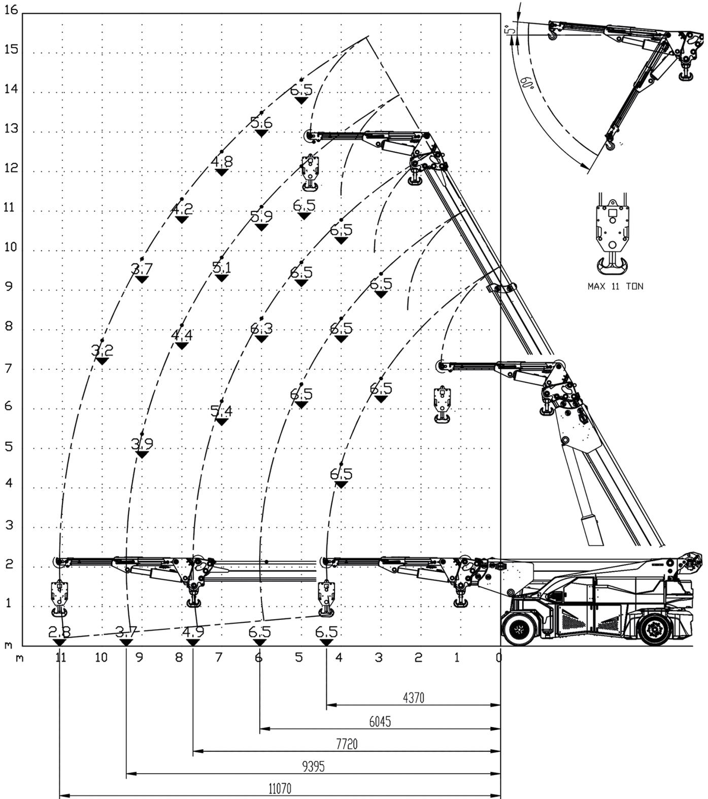
**Flèche de base avec Jib hydraulique extensible 6,5t + treuil + stabilisateurs**
