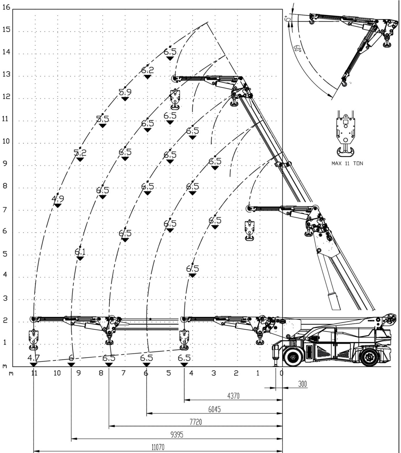
**Flèche de base avec GEKO mécanique a 80°**
