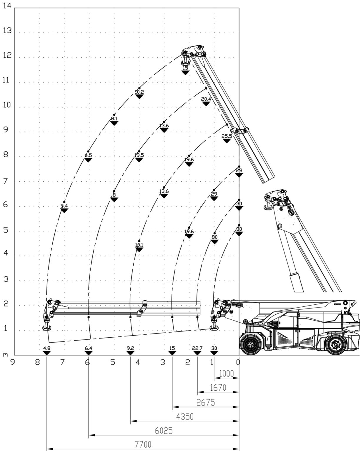
**Flèche de base avec crochet de base avec stabilisateurs**
